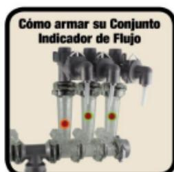
Los Indicadores de Flujo Wilger utilizan una esfera para la indicación visual de cualquier variación de flujo entre las diversas columnas. Son útiles para detectar obstrucciones en la aplicación de flujo con caudales que van desde 0.01 us/gpm hasta 2.7 us/gpm.
