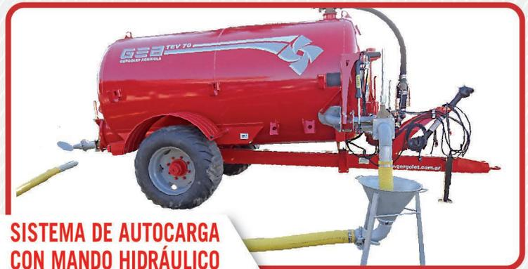
**SISTEMA DE AUTOCARGA CON MANDO HIDRÁULICO**
